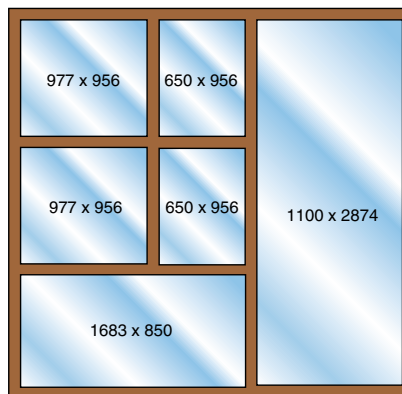
Exemple de montage (en mm) Cloison filante – longueur infinie
