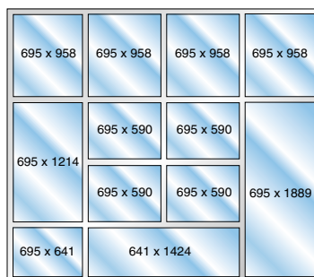
Exemple de montage (en mm) Cloison filante - Longueur infinie
