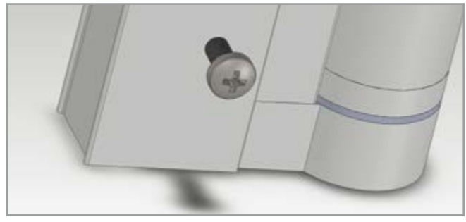
Fixation du profil de compensation et du profil de connexion par le biais de trois vis M4
