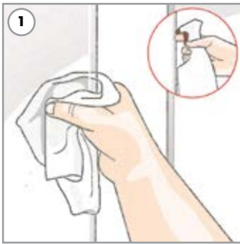
1. Nettoyer le bord du verre avec de l'alcool isopropylique.
