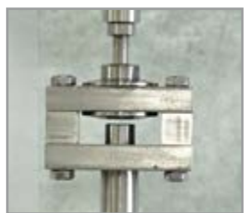
ESSAI DE RÉSISTANCE À LA TRACTION - F_n F_n \text{ max} = 890 \text{ daN} (1 daN correspond environ au poids de 1 kg)
