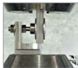
ESSAI DE RÉSISTANCE À LA COUPE - F_t F_t \text{ max} = 500 \text{ daN} (1 daN correspond environ au poids de 1 kg)
