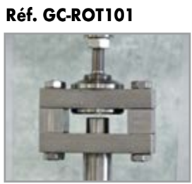
Réf. GC-ROT101 ESSAI DE RÉSISTANCE À LA TRACTION - Fn Fn max = 380 daN (1 daN correspond environ au poids de 1 kg)
