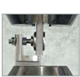
ESSAI DE RÉSISTANCE À LA COUPE - Ft Ft max = 500 daN (1 daN correspond environ au poids de 1 kg)
