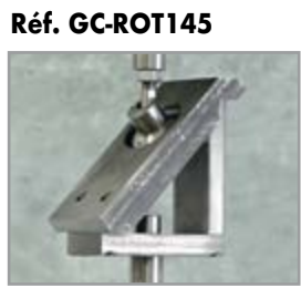
Réf. GC-ROT145 ESSAI DE RÉSISTANCE À LA TRACTION - F F max = 550 daN (1 daN correspond environ au poids de 1 kg)
